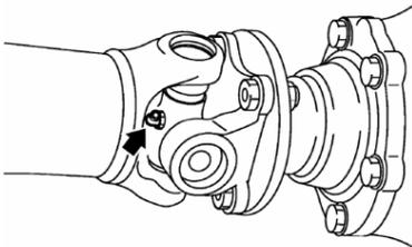
El cardan debe ser lubricado regularmente, mediante la grasera en medio de la cruceta.
