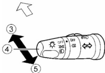
③ En la posición
