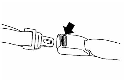
El seguro de hebillas del cinturón medio se identifica por marcas, y el seguro de resorte solo funciona con las hebillas de la mitad.
