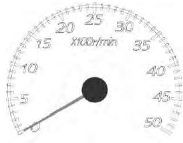
El tacómetro indica la velocidad rotacional del motor en rpm, (Revoluciones por minuto). El motor tendrá una
