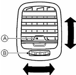
**Las salidas laterales de aire y del medio:** use (A) para abrir o cerrar las rejillas, y use (B) para ajustar la dirección del flujo.
