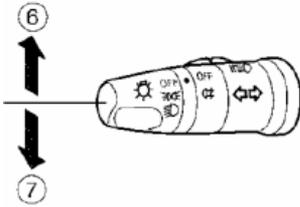
Gire la palanca de operación a la derecha hasta llegar al punto ⑥, o gire la palanca de operación a la izquierda para alcanzar el punto ⑦. La palanca de operación regresara a la posición original automáticamente cuando el vehículo haga el giro deseado.
