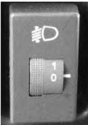
El eje óptico horizontal de las luces delanteras, puede ser ajustado de acuerdo al número de personas en cabina y la carga.
