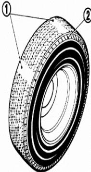
Las llantas deben ser regularmente inspeccionadas para revisar si hay desgaste, grietas u objetos incrustados en la superficie o huella. Si hay gasto excesivo, grietas, o cortes profundos, la llanta debe ser reemplazada.
