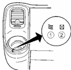
El portavasos está cercano a ambas rejillas de aire a los dos lados del millaré. La salida de aire en el portavasos está controlado por un suiche deslizante; así tenemos que: cuando está en la posición ① está abierto, ② está
