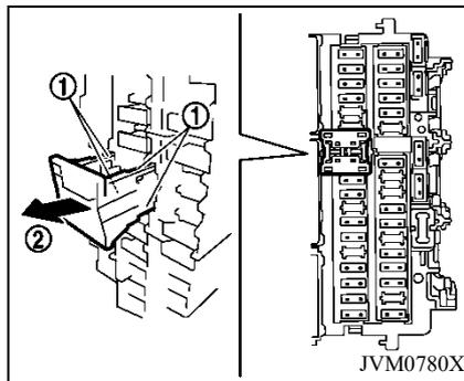
Para evitar el agotamiento de la batería, el interruptor de fusible de almacenamiento extendido está desconectado durante la entrega. Antes de la entrega del auto, este interruptor fue empujado hacia adentro, y se permanece encendido
