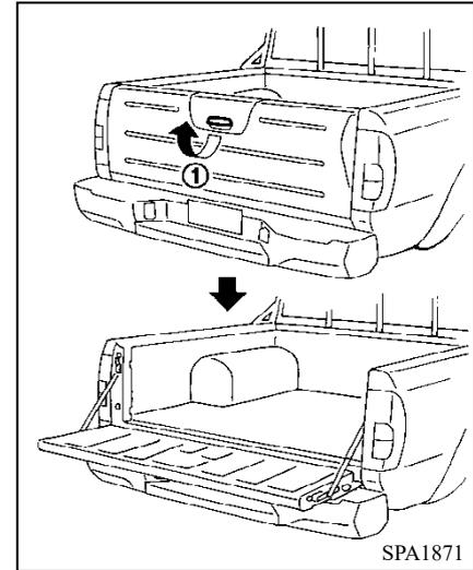
Para abrir el tablero de bloqueo trasero, jale la palanca de apertura ① del tablero de bloqueo trasero para bajar el tablero de bloqueo trasero. Las tiras de soporte en ambos lados pueden mantener el tablero de bloqueo trasero en el estado abierto.
