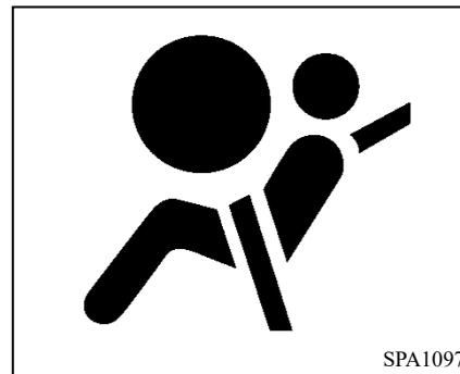
La luz de bolsa de aire de seguridad auxiliar se muestra como
