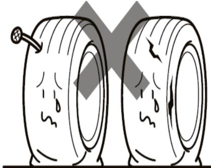
Varios neumáticos han sido perforados por clavos (un líquido de fuga sólo puede reparar un neumático)
