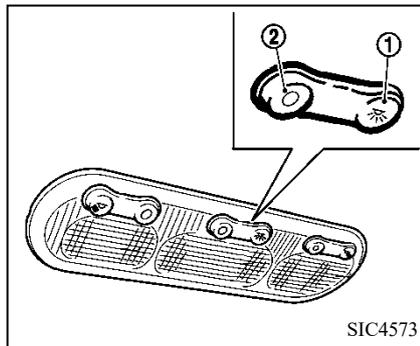
El interruptor de luz de mapa tiene tres posiciones: ① “Encendido”, ② “Apagado” y la posición central.
