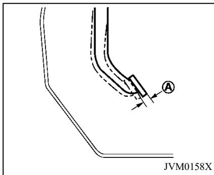
Cuando el modo de alimentación del auto se encuentra en READY, verifique la holgura libre del pedal del freno Ⓐ. Si excede el rango abajo mencionado, póngase en contacto con el punto de servicio autorizado por Auteco.
