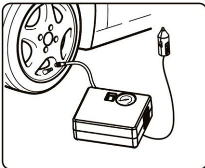
Modo de inflado en la reparación del neumático
