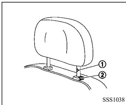
1. Alinee las barras del reposacabezas a los agujeros del asiento. Asegúrese de que el reposacabezas mire hacia la dirección correcta. La barra del reposacabezas con ranura ① debe alinearse al agujero con botón de bloqueo ②.
