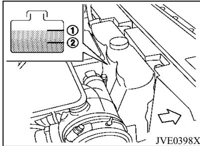
Después del enfriamiento del electromotor y el controlador del electromotor, verifique el nivel del líquido refrigerante en el tanque de líquido. Si el nivel del líquido refrigerante está por debajo de la línea MIN ②, agregue el líquido refrigerante a MAX ①. Si el tanque de líquido está vacío, verifique el nivel del líquido refrigerante en el radiador después del enfriamiento del controlador del electromotor. Si hay insuficiente líquido refrigerante en el radiador,
