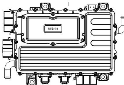
La etiqueta de advertencia de alto voltaje del 3 en 1 se pega en la posición indicada en la figura
