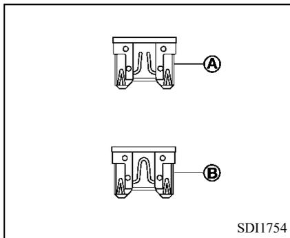
8. Si el fusible está desconectado ①, reemplácelo con el nuevo ②.
