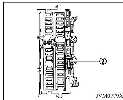
6. Utilice la pinza de fusible colocada dentro de la caja de fusible de la cabina de conducción para quitar el fusible.
