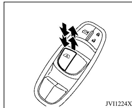
Los interruptores con marca **A** en su superficie tienen función de ascenso y descenso automáticos.
