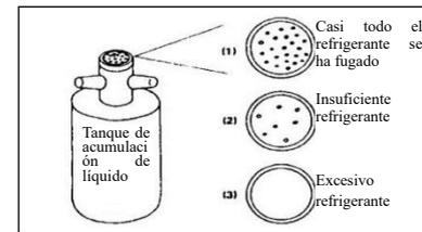
2) Inspección de la falla de refrigeración del acondicionador de aire
