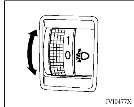
Cuando el interruptor de ignición está en "ON" y los faros delanteros están encendidos, el control de regulación de luz de los faros delanteros empieza a funcionar, se permite regular el eje óptico de los faros delanteros según las condiciones de conducción.
