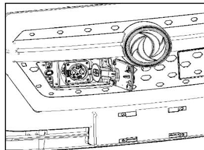
② Abra la tapa del puerto CC: Accione la hebilla en la base del puerto de carga para abrirla.
