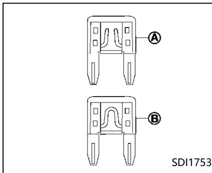
verifique el enlace fusible. Si cualquier enlace fusible se ha fundido, reemplácelo con el producto genuino de NISSAN.
