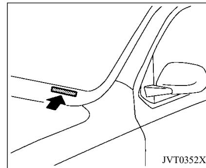
La placa del número de identificación del auto (VIN) se fija en la posición indicada en la figura.
