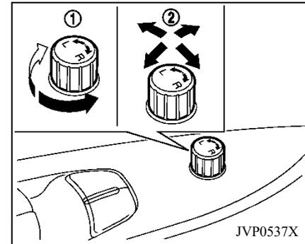
Cuando el interruptor de ignición se encuentra en "ACC" o "ON", el control remoto de los espejos laterales funciona.
