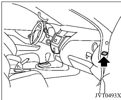
La placa de identificación del auto se fija en la posición indicada en la figura.
