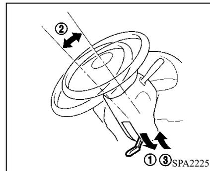
Jale la palanca de bloqueo ① hacia abajo, regule el volante hacia arriba o abajo ② hasta la posición necesaria.
