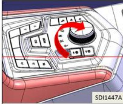
Jale el interruptor del freno de estacionamiento electrónico suave y establemente hacia arriba, el interruptor no debe bloquearse y el sonido de funcionamiento del electrónico del freno de estacionamiento electrónico debe ser normal. Si el sonido de funcionamiento del electromotor es normal o la luz de falla de estacionamiento electrónico visualizada en el instrumento se permanece encendida o parpadea, póngase en contacto con el punto de servicio autorizado por Auteco.
