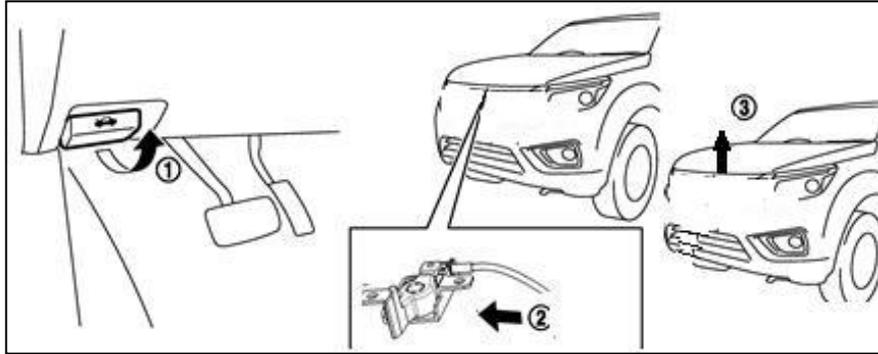
1. Jale la palanca de apertura ① de la cerradura del capó del motor por debajo del tablero de instrumentos hasta que el capó del motor salte.
