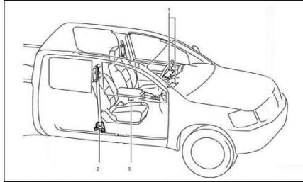
1. Módulo de bolsa de aire de seguridad de colisión frontal auxiliar
