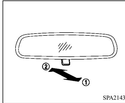
Al conducir durante la noche, si el deslumbramiento de los faros delanteros del auto detrás de lo suyo afecta su visión, jale la palanca de regulación ① hacia abajo.
