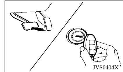
Si la energía de la batería de llave inteligente está agotada, o las condiciones ambientales generan interferencias al funcionamiento de la llave inteligente, arranque el auto según los pasos siguientes:
