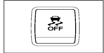
En la mayoría de las condiciones de conducción, al conducir el auto, debe activar el sistema de control dinámico (ESP) del auto.
