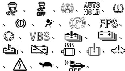
Si cualquier luz indicadora no se enciende o no funciona según dicho estado, significa que la bombilla puede haber sido quemada o hay falla en el circuito del sistema eléctrico. Verifique el sistema inmediatamente en el punto de servicio autorizado por Auteco, si es necesario, realice la reparación.
