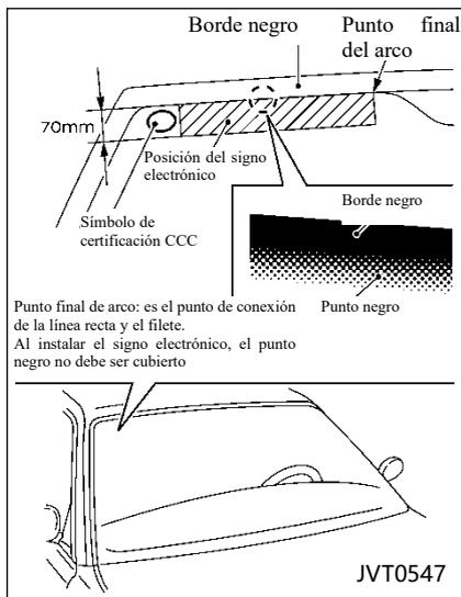
En el parabrisas delantero del auto se ha establecido la ventana de microondas usada para la instalación del signo electrónico y la lectura de datos. Instale el signo electrónico en la posición indicada en la figura.
