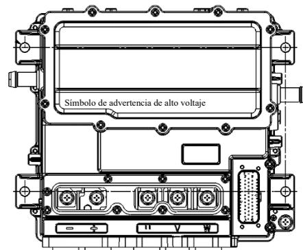
La etiqueta de advertencia de alto voltaje del controlador del electromotor se pega en la posición indicada en la figura
