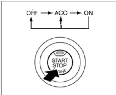
Sin que el pedal de freno esté pisado, presione el interruptor de arranque, la secuencia de conmutación de la fuente de alimentación del auto se muestra a
