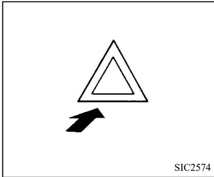
A menos que la batería auxiliar esté agotada, de lo contrario, no importa la posición del interruptor de ignición, las luces de advertencia de peligro pueden funcionar.
