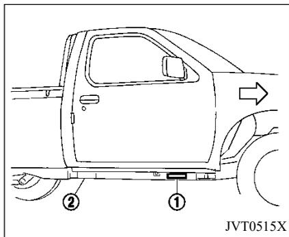
El número de identificación del auto (número de chasis) se graba en la posición ① sobre el bastidor ② como se muestra en la figura siguiente.
