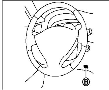
Los sensores A y B en el tablero de instrumentos pueden ayudar a mantener la temperatura constante dentro del auto. No coloque ningún artículo sobre o en los alrededores del sensor.
