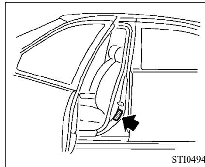
La presión del neumático en estado frío se indica en la placa de identificación del neumático, la placa de identificación se fija en la columna vertical central del lado del conductor.
