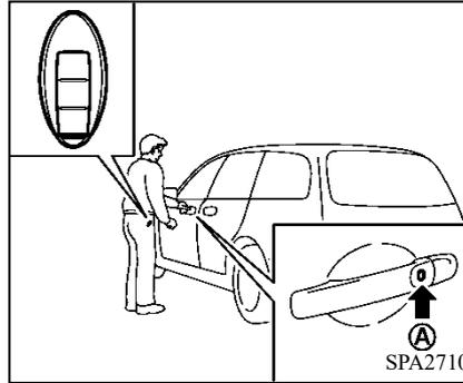
Cuando lleva la llave inteligente con usted, puede presionar el interruptor de solicitud del tirador dentro del alcance de operación de la llave inteligente (lado del conductor o lado del pasajero delantero) **A** con el fin de bloquear o desbloquear todas las puertas.
