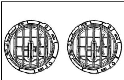
Mueva la palanca en el centro de la apertura de escape (arriba / abajo, izquierda / derecha) para regular la dirección de escape de la apertura de escape a la posición necesaria.
