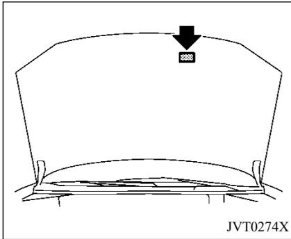
La etiqueta de advertencia del acondicionador de aire se pega en la posición por debajo del capó del motor como se muestra en la figura siguiente.
