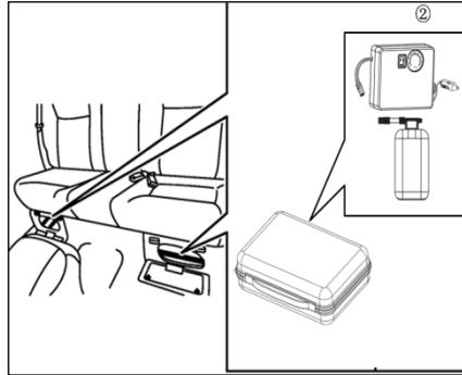
1. Retire la cubierta del compartimiento de herramientas ① .
