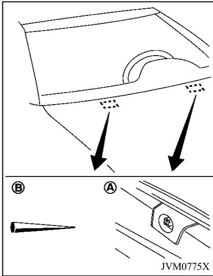
Tenga en cuenta de no bloquear la boquilla del pulverizador de agua ①. De lo contrario, el lavador de parabrisas puede no funcionar normalmente. Si la boquilla está bloqueada, resuélvalo con alfiler o clavo ②, no dañe la boquilla.
