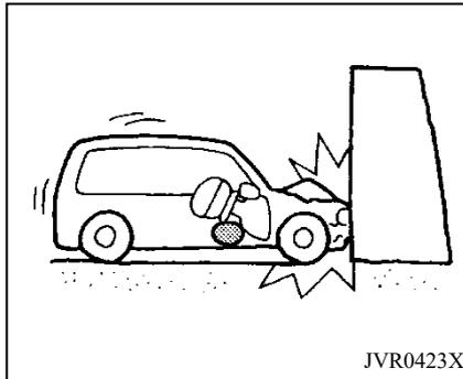
Cuando se produce una colisión frontal con la pared sólida inmóvil y no deformable en una velocidad superior a 25km/h, el sistema de bolsa de aire de seguridad de colisión frontal auxiliar se desplegará.
