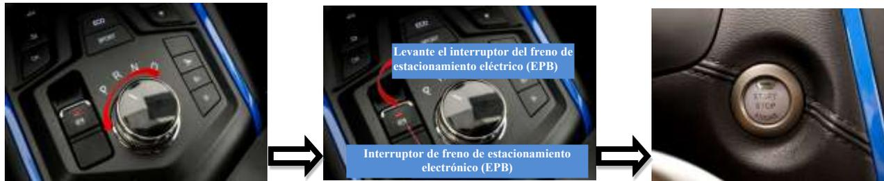
Pise el pedal de freno → estacione el vehículo → cambie la marcha a la posición “P” → levante el interruptor del freno de estacionamiento eléctrico (EPB) → presione el botón “Encender/Apagar” para apagar el vehículo.
