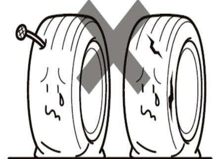
Varias llantas han sido perforadas por clavos (una botella de sellador de llantas solo puede reparar una llanta).
