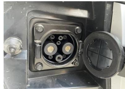
② Abra la tapa impermeable y a prueba de polvo del puerto de carga de corriente continua: presione el pestillo en el puerto de carga de corriente continua para abrirlo.
